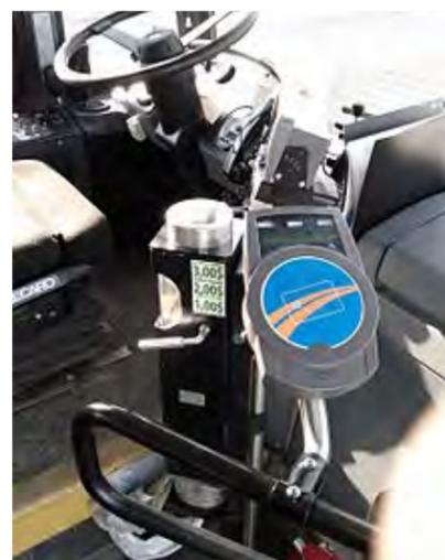
Figure 2 : Valideur de titre à bord d'un autobus
